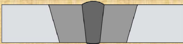
JUNTA CHANFRADA EM "V" SOLDADA
