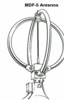
ANTENA DE QUADRO COM ANTENA DE SENTIDO
