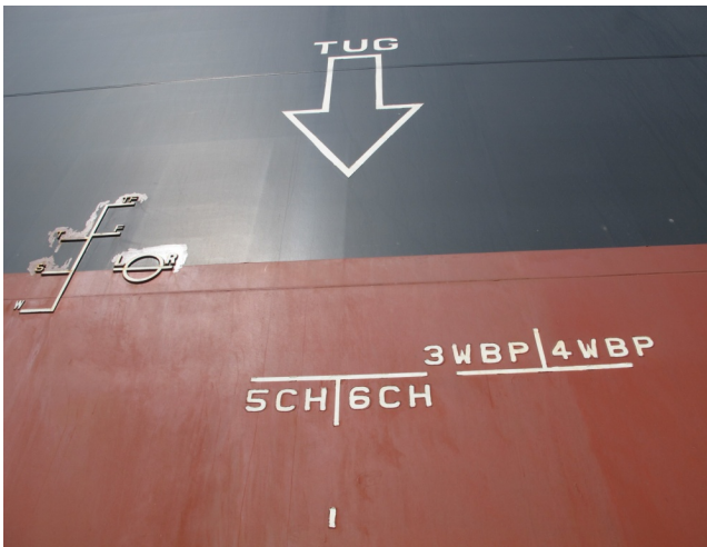
PONTO DE APLICAÇÃO DA PROA DE REBOCADOR (TUG)
