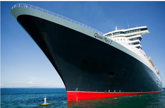
BULBO DE PROA NO NÍVEL DO PLANO DE FLUTUAÇÃO
