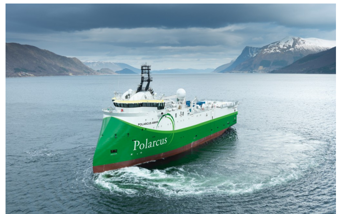
GIRO COM AUXÍLIO DE “BOW THRUSTER”
