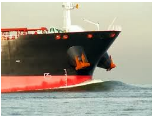
ONDA DE PROA REDUZIDA PELO BULBO
